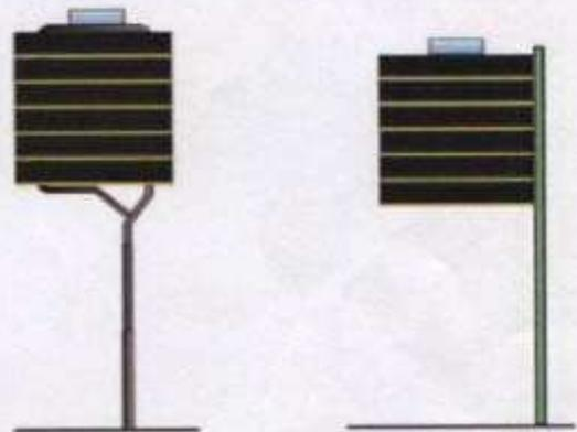
3) Impianto standard costituito da 2 pali zincati che sostengono le frecce tramite collari
